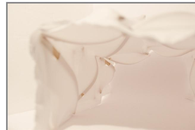
Diskontinuierlicher **Druck** (Holzleisten) und kontinuierlicher **Zug** (Stoffhülle)
