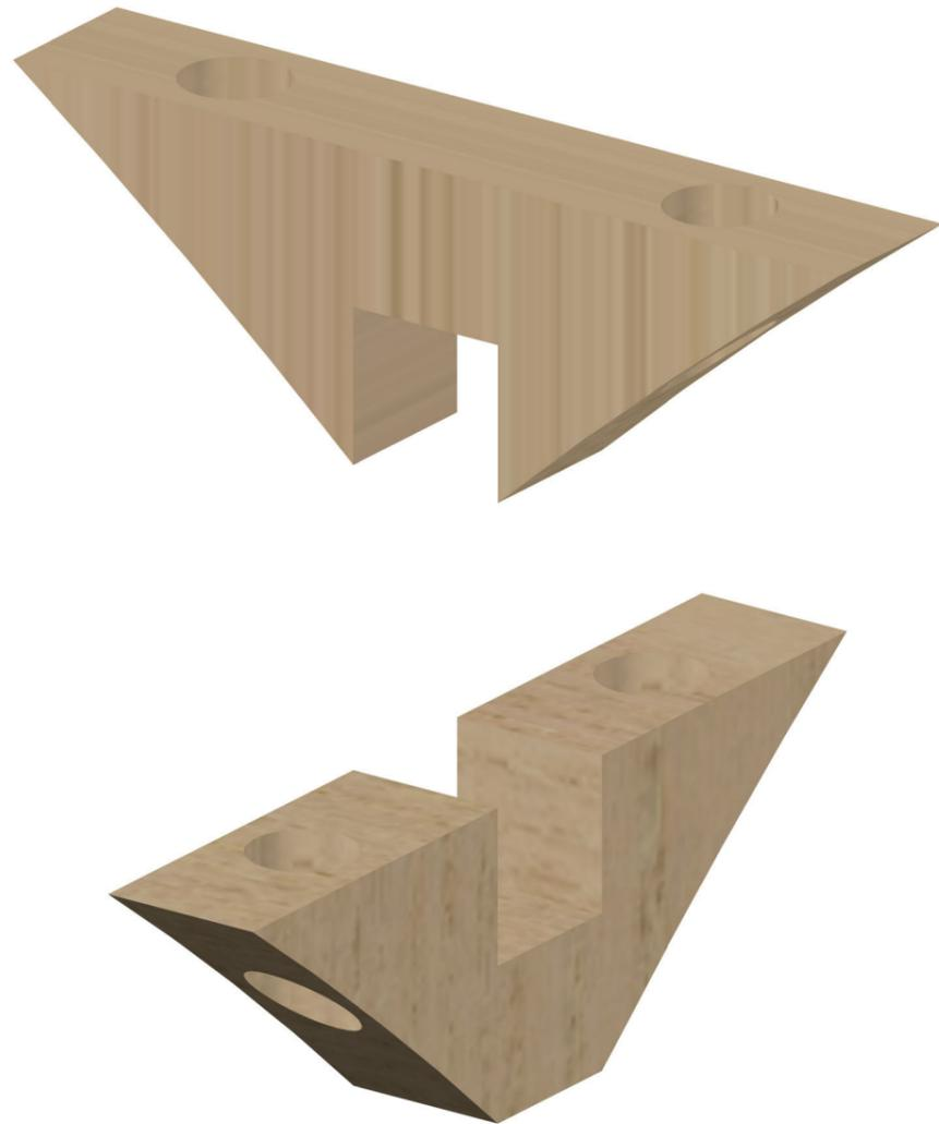
Material: Multiplexplatte, paßgenau auf Holzleistenbreite zugeschnitten
