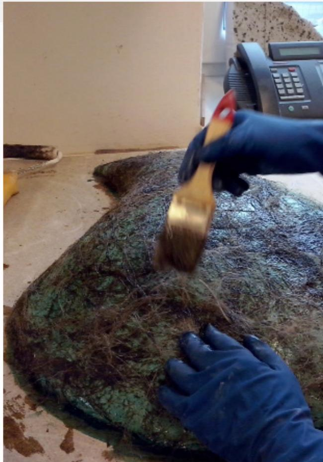
Die Hanffasern werden Schicht für Schicht auf die Positivform auf-laminiert.
