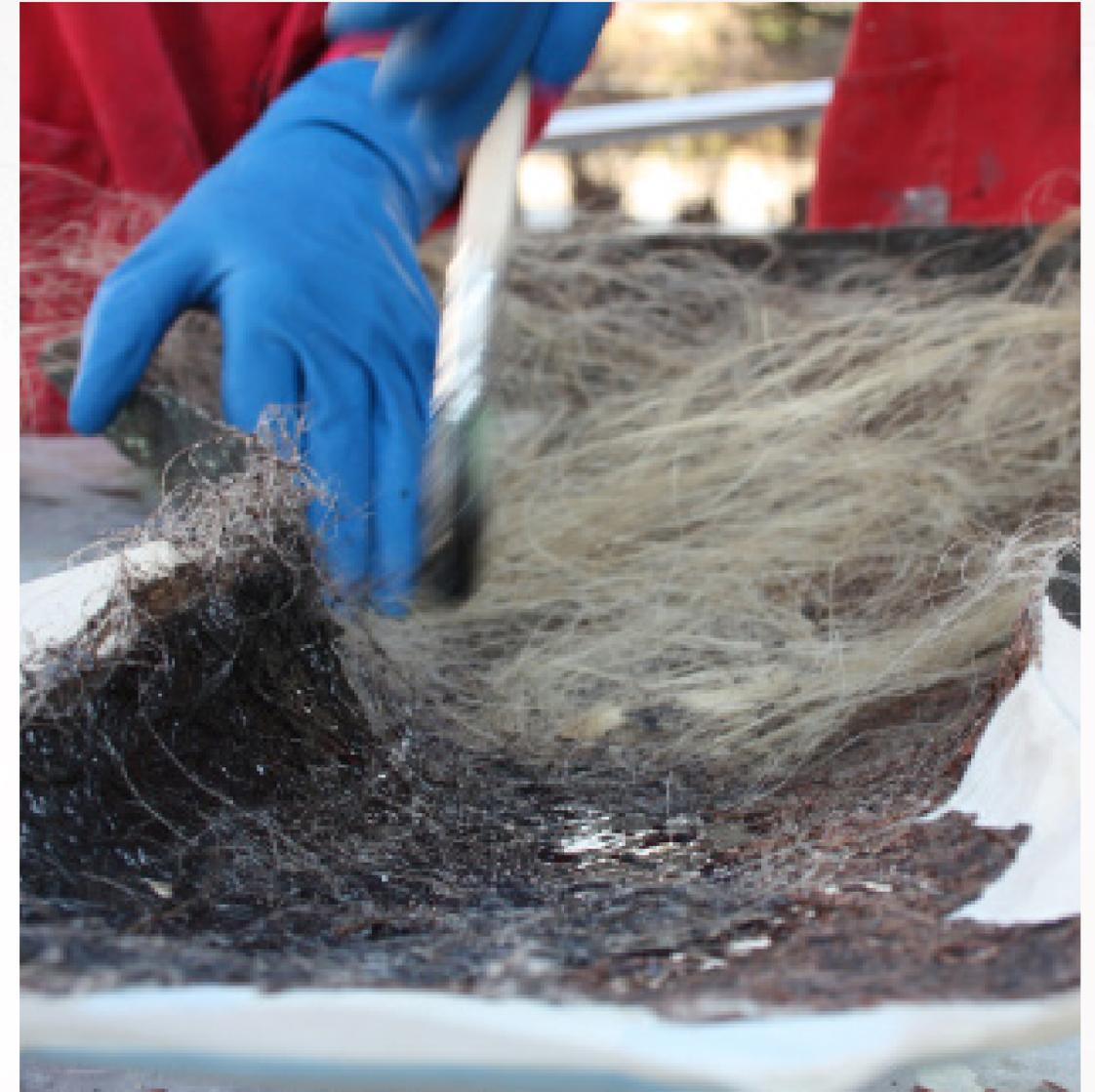
Auf den oben vorliegenden Bildern wird gezeigt, wie die Hanffasern in die Negativform hinein laminiert werden. Im Becher befindet sich eine Mischung aus Bioresin, Kaffeesud und Farbpigmenten die vorsichtig auf die Fasern aufgespritzt wurde.
