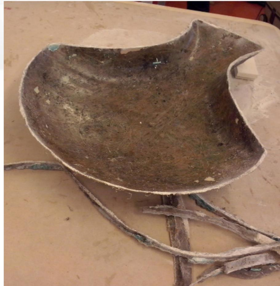
Der ausgehärtete Teil wird in weiterer Folge von der Positivform getrennt. Die Kanten werden auf eine gleichmäßige Ebene gebracht.
