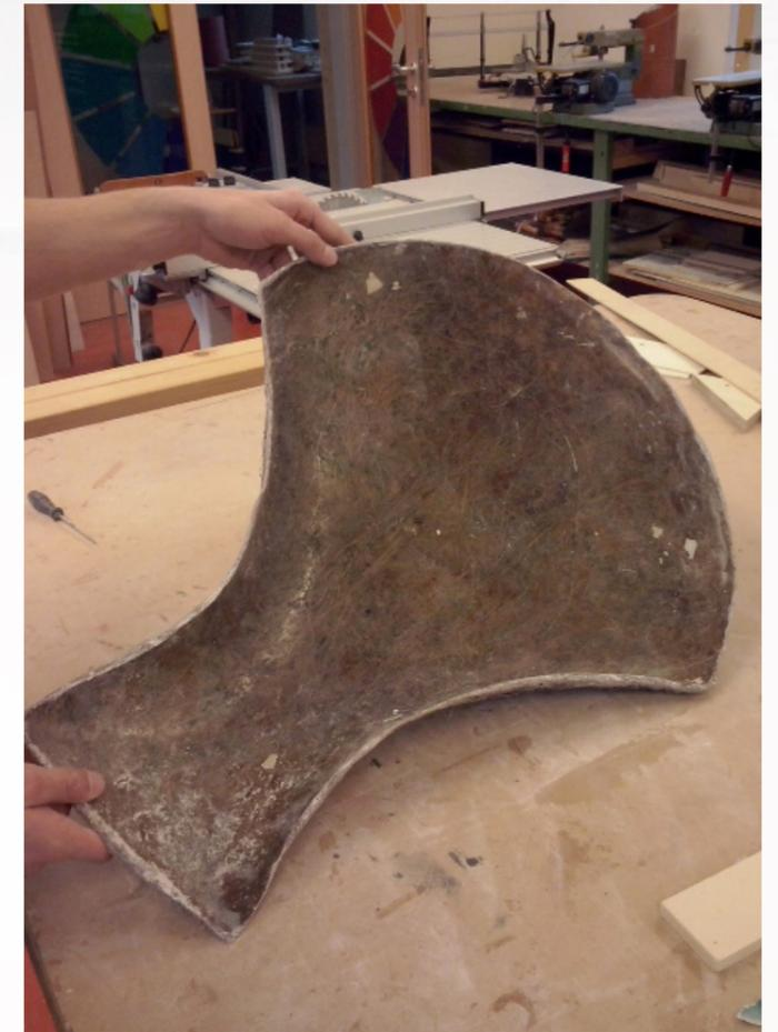
Das Laminierte Werkstück kann nun als Negativform eingesetzt werden.
